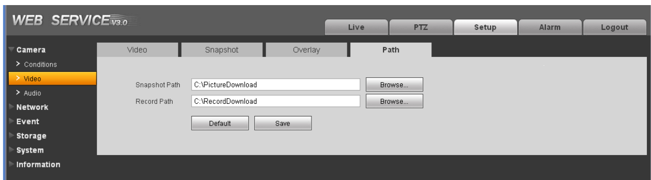
Figure 4-5. Настройка пути сохранения моментальных снимков и видео.
