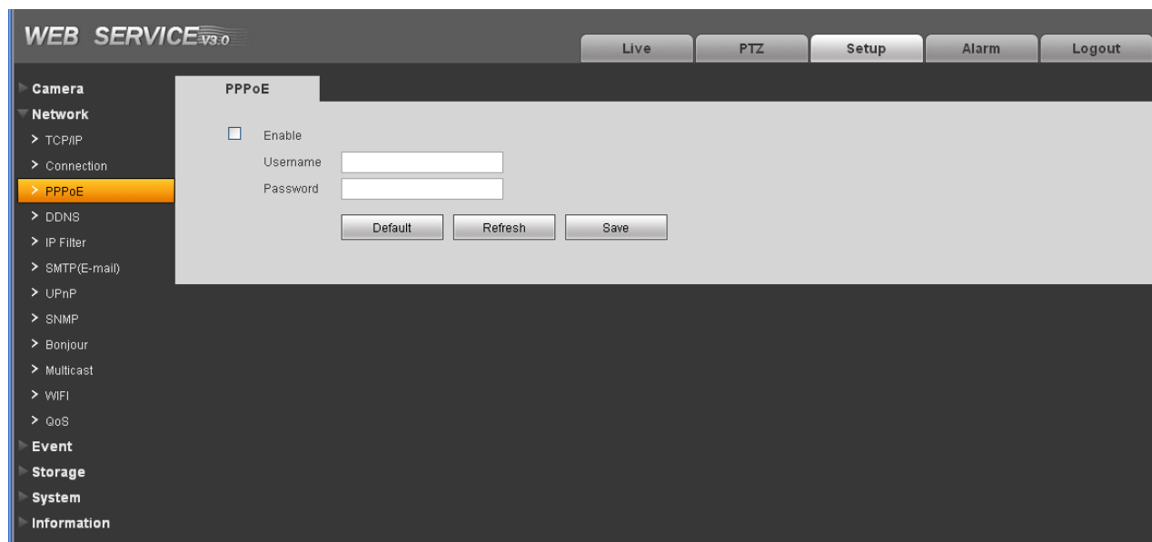
Рисунок 4-9. Настройки PPPoE соединения.
